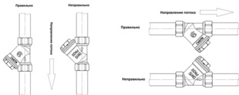
Рисунок 4– Схема установки сетчатого фильтра
